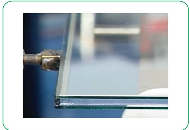
Hotmelt H350: el sellador termofusible está diseñado para el sellado secundario de las unidades DVH (Doble vidrio hermetico) El material está diseñado para su uso con el extrusor de hotmelt
